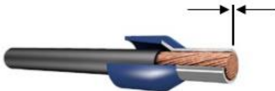
Abb. 4: aus dem Kupferrohr ragende Leiterlitzen
