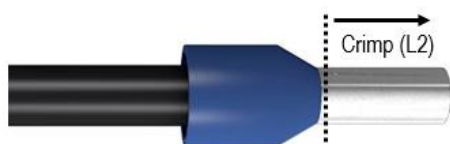
Abb. 6: Positionierung des Crimps
